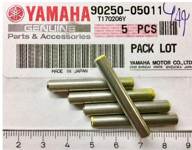
Kuva 3. Yamaha 20 hv perämoottorin murtosokkia, kooltaan 35 mm x 4,96 mm.
