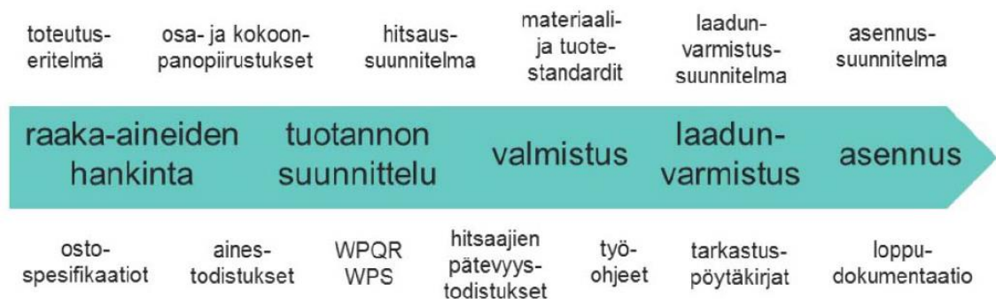
Kuva 1. "Osa kantavan teräsrakenteen toteutukseen liittyvää, perinteistä prosessia ja siihen liittyvää dokumentaatiota" (Kauppi & Toppila 2018, s. 17).
