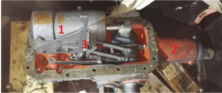
Kuva 5. Massey-Ferguson 575 Multipower -traktorin nostolaittekansi ja nostosylinteri.
