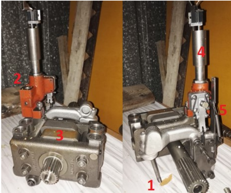
Kuva 4. Massey-Ferguson 575 Multipower -traktorin hydraulipumppu kuvattuna akselin molemmista päistä.
