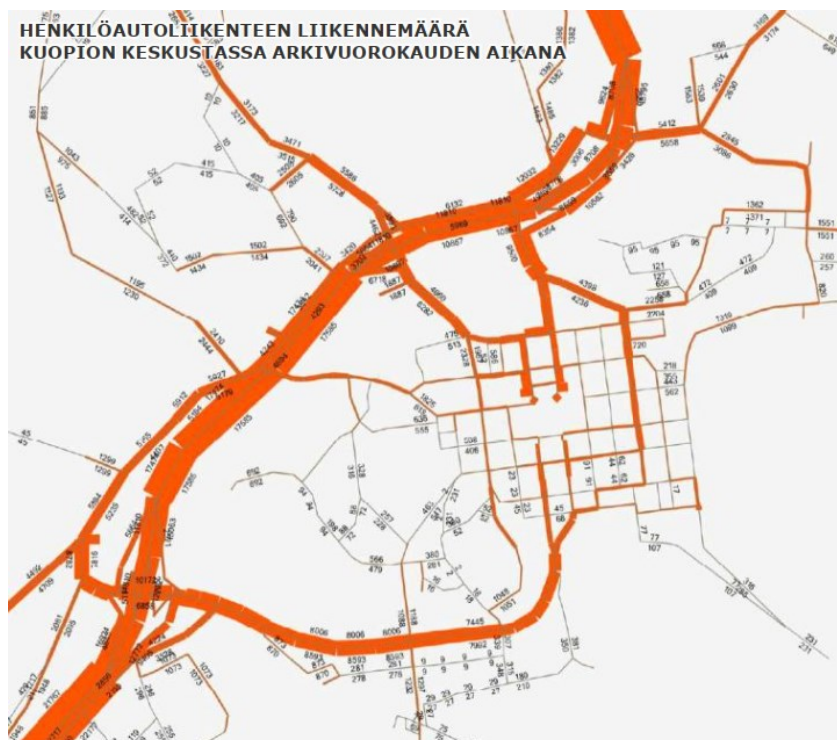
Kuva 4: Henkilöautoliikenteen liikennemäärä Kuopion keskustassa arkivuorokauden aikana. Malli on tuotettu makroskooppisella Emme-ohjelmistolla. (Nissinen 2020)
