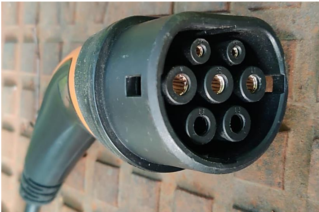
Kuva 1. Tyypin 2 latauspistoke. (Hiltunen 2022)
