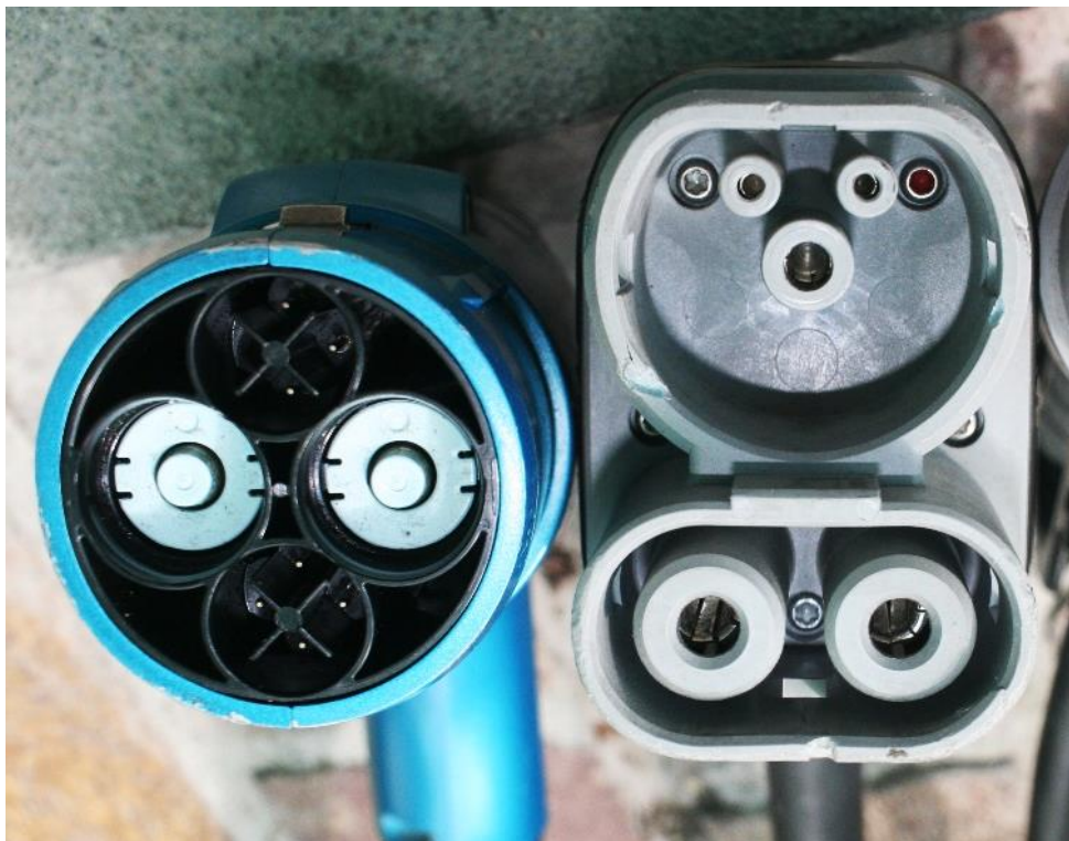
Kuva 2. Pistoketyypit CHAdeMO ja CCS2. (Paul Sladen 2017)
