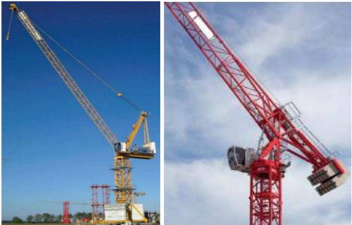
Kuva 5. Puristepuominosturit: vasemmalla vaijerikäyttöinen, oikealla hydraulikäyttöinen (Marchand & Watson 2019).
