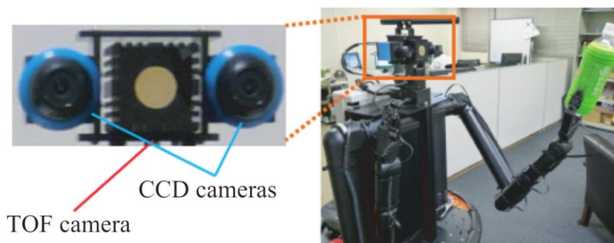
Kuva 6. TOF-kameroita käytetään aktiivisina antureina kolmiulotteisen tiedon nopeaan ja tarkkaan keräämiseen. Ne yhdistetään CCD-kameroiden kanssa visuaaliseksi anturiksi,
